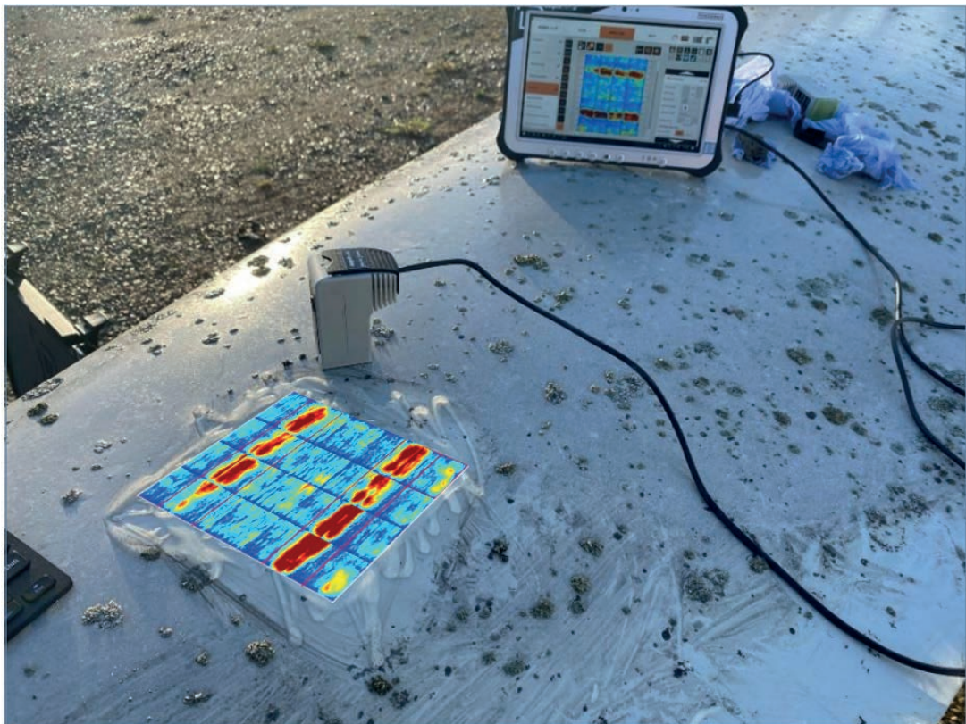
Figur 3. C-scan overlegg av en vindturbinbladinspeksjon, som viser områdene av lim binding med de indre spaltene (røde linjer)
